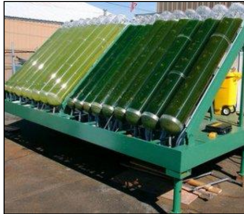
Figura 4 - Sistema de cultivo fechado (fotobiorreator).
