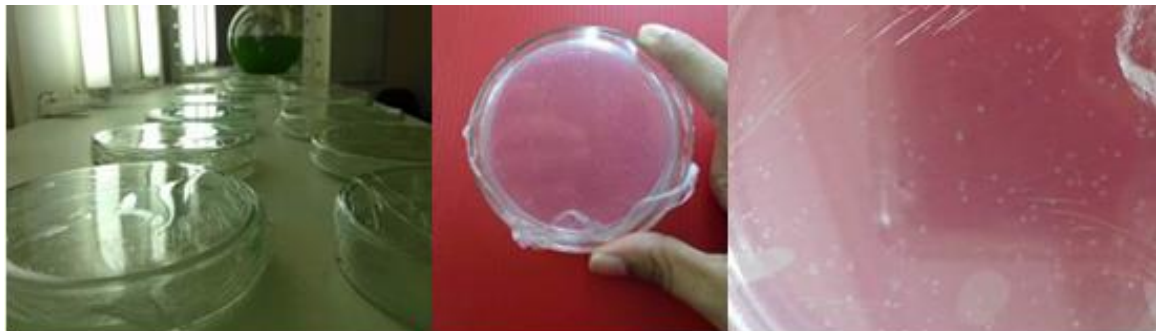
Figura 12 - Placas Petri com Meio ASM-1 solidificado com amostras do efluente para tentativa de isolamento de cepa. Agosto de 2015.
