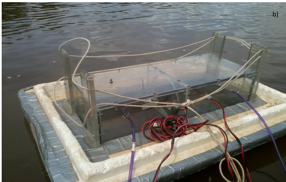
Figura 3 – a) Desenho esquemático da câmara flutuante; b) câmara flutuante no canal do rio. Fonte: Adaptado de Gomes, 2009 e arquivo pessoal.
