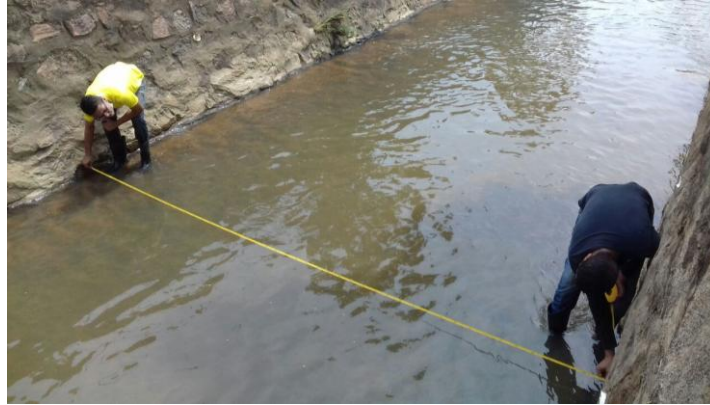
Figura 9- Extração dos dados hidráulicos para obtenção da vazão.
