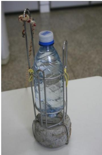
**Figura 11** - Coletor utilizado nas coletas de água.
