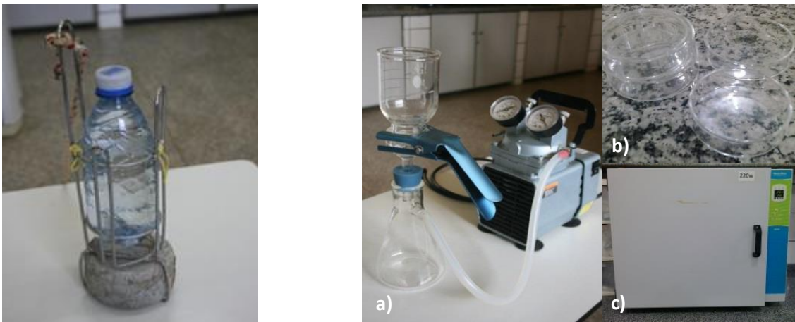
Figura 6- Coletor de água subterrânea. Figura 7- a) Bomba a vácuo e sistema Kitassato, Fonte: Os organizadores. b) Placa de Petri c) Estufa bacteriológica.
