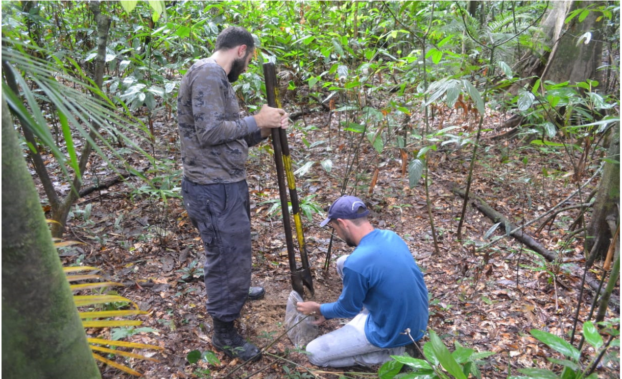
Figura 3 – Coleta do solo das margens dos rios com uso de uma boca de lobo e armazenamento em saco plástico.
