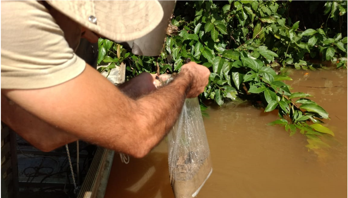
Figura 4 – Coleta do sedimento do rio com o auxílio da draga de Eckman , e armazenamento em saco plástico.
