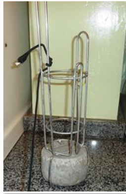
Figura 3 - Coletor de água de poço. Fonte: Os organizadores, 2013.
