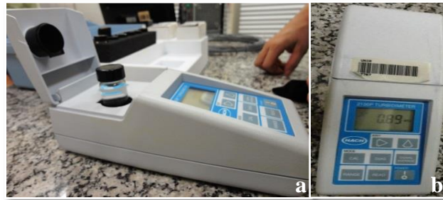
Figura 4 - Turbidímetro de bancada: (a) aparelho aberto e (b) aparelho fazendo a leitura – LABLIM. Fonte: Os organizadores, 2013.
