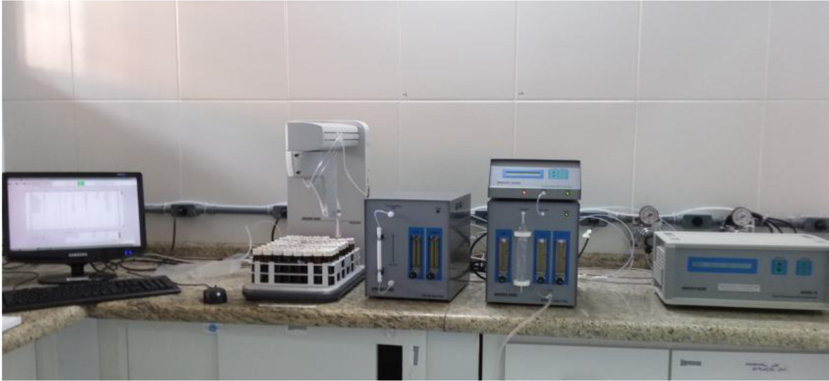
Figura 10 - Cromatógrafo gasoso acoplado ao espectrofotômetro de fluorescência atômica. Fonte: Leidiane Caroline Lauthartte.
