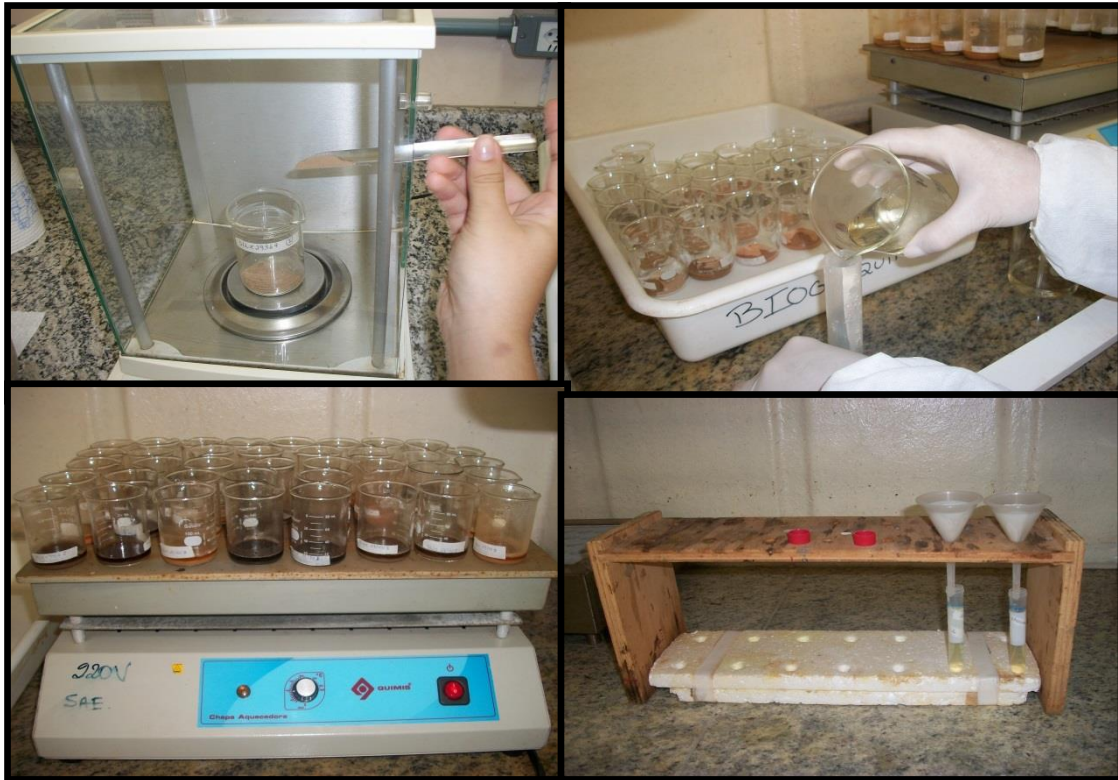
Figura 5. Pesagem, adição dos reagentes, digestão do solo para extração química dos metais em chapa aquecedora e filtragem das amostras. Fonte: Organizador (2012).
