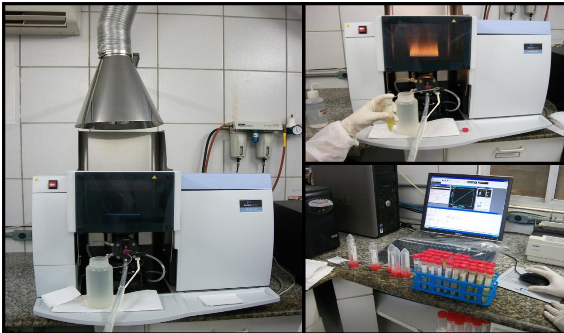
Figura 6. Espectrofotômetro de absorção atômica por chama e leitura dos metais. Fonte: Organizador (2012)
