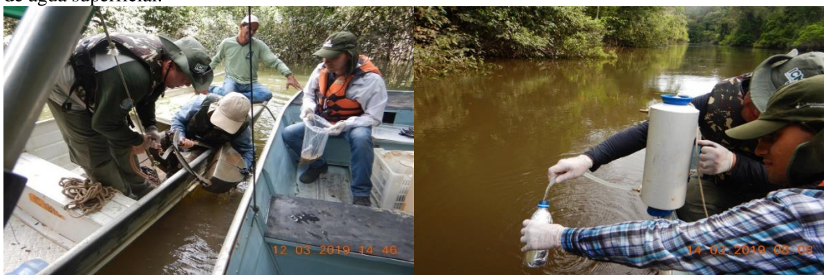
Figura 6 - a) Draga de Van Veen para coleta de sedimento de fundo. b) Garrafa de Van Dorn para coleta de água superficial.
