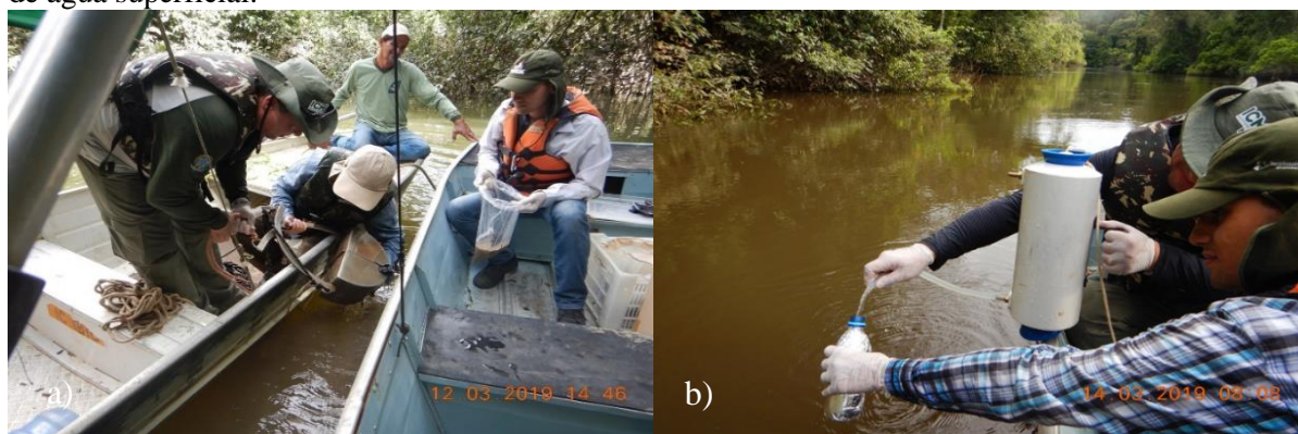
Figura 7 - a) Draga de Van Veen para coleta de sedimento de fundo. b) Garrafa de Van Dorn para coleta de água superficial.
